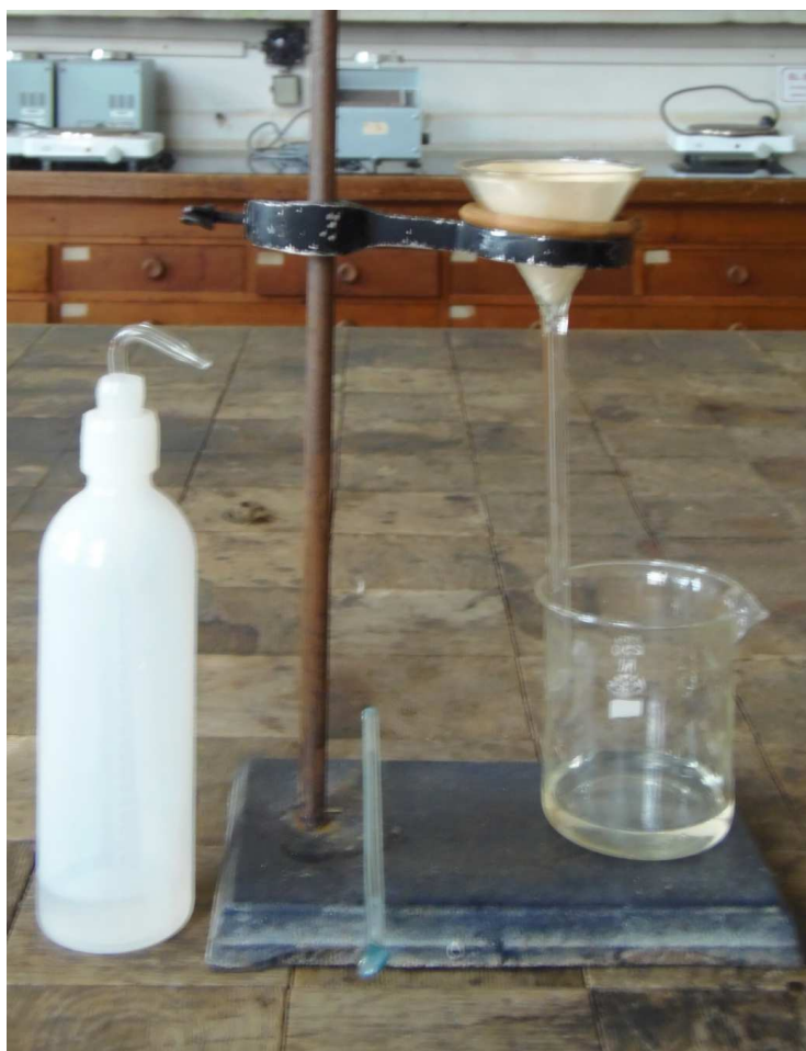
Obr. č.2 Filtrace
