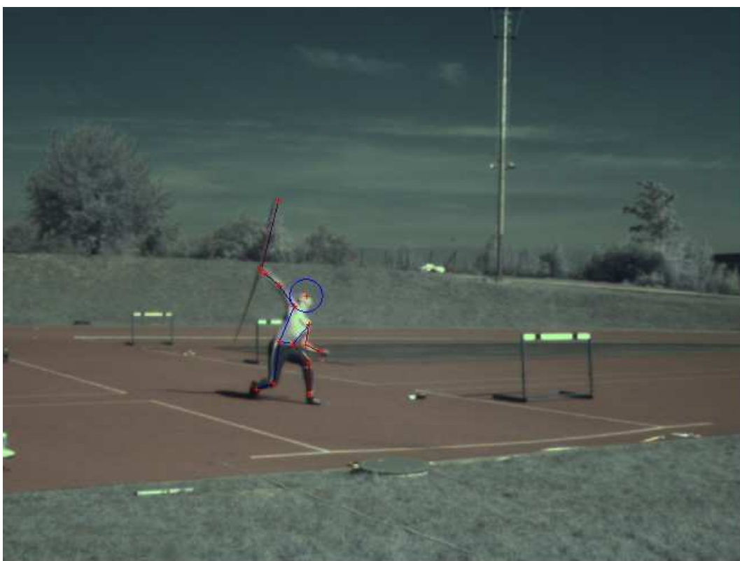
Obr. 18 – Reflexní body umístěné na hlavních kloubech atleta a zobrazené trackovacím systémem softwaru SIMI Motion
